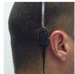
Bild 5 Aufgesetzter Knochenleitungshörer
