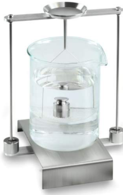
Abb.2: „Wägung in Prüfflüssigkeit“
