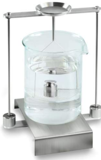
Abb.2: „Wägung in Hilfsflüssigkeit“
