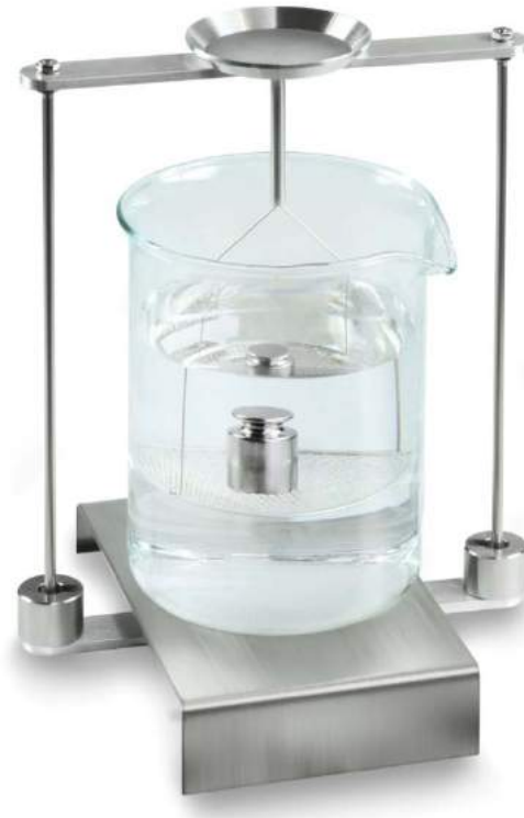
Abb.2: Wägung in Hilfsflüssigkeit
