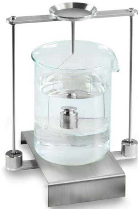
Abb.6: Wägung in Prüfflüssigkeit
