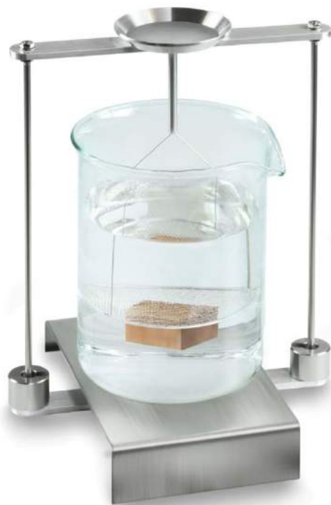
Abb.4: Wägung in Hilfsflüssigkeit
