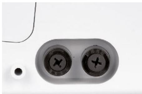
Die Sicherungen sind auf der Geräteunterseite montiert. Verwenden Sie einen passenden Schlitz- oder Kreuzschraubendreher (gegen den Uhrzeigersinn) um die Sicherungen zu entfernen.
